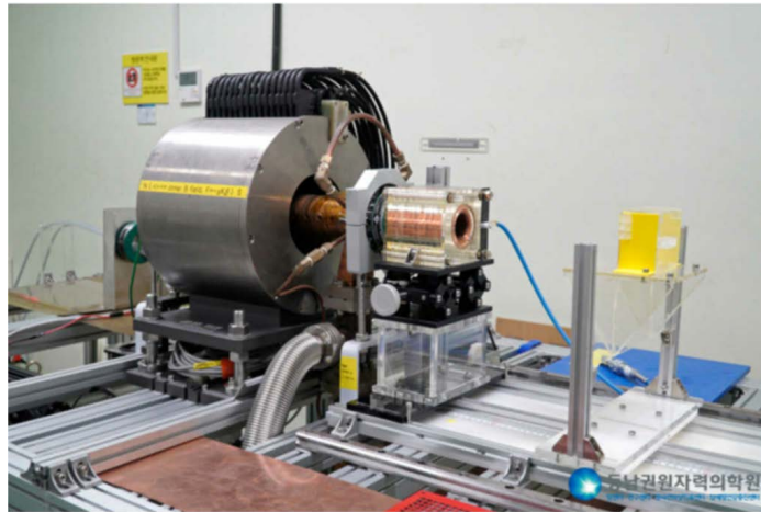
[그림 1] 자체 개발 플래시 전자 발생 전자선형가속기 (약 5 MeV, 동남권원자력의학원)
