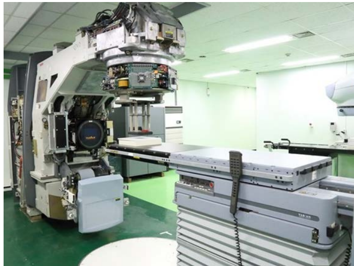
[그림 2] 기존 전자선형가속기를 개조한 플래시 전자 발생 시설 (약 10 MeV, 한국원자력의학원)
