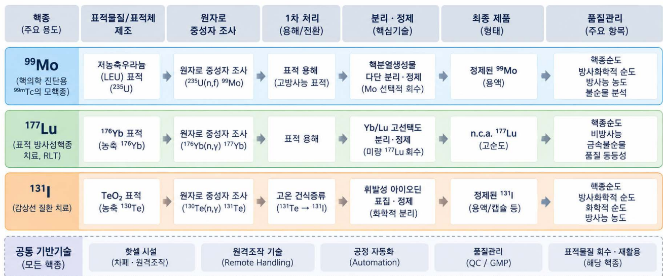
[그림 1] 주요 원자로 생산 의료용 RI의 생산공정 및 핵심기술
